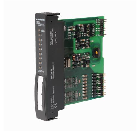
Das Eingangsmodul DF20-N ist mit acht Kanälen nach NAMUR ausgestattet, die zu zwei Blöcken zusammengefasst sind. Pro Block gibt es einen Frequenzeingang und drei Steuerein-/ausgänge.
