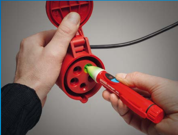
Drehfeldrichtungsprüfung an CEE-Kupplung mit TRITEST® easy
