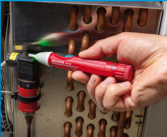
Prüfung eines Magnetventils mit BENNING VT 2
