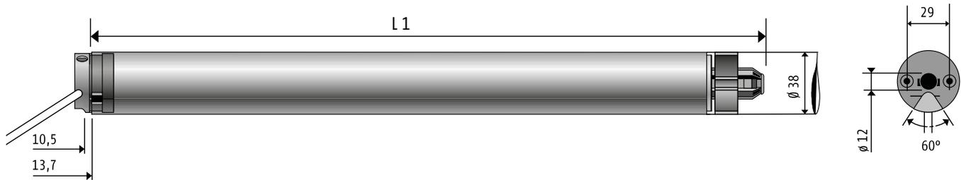
**230 V, 50 Hz - Basisausführung: mit Adapter, Mitnehmer, 1 m Kabel schwarz (bei Kurzantrieb 2,5 m weiß) und Blendkappenlager**
