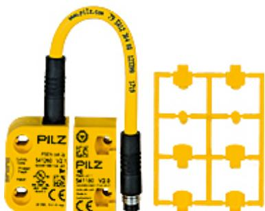
RFID Sicherheitsschalter 2 sichere HL-Ausgänge, 8-pol. M8 Stiftstecker, eine Betätigungsrichtung, Unterstützung für SDD, IP67, Schaltabstand 11 mm, Sao = 8 mm, Sar = 20 mm, VP = 1 Stück codierter Schalter mit Betätiger.
