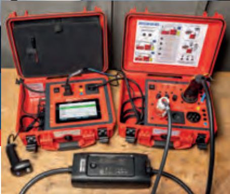
Prüfung einer 3-phasigen Ladeleitung Mode 2
