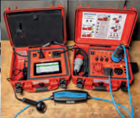
Prüfung einer 1-phasigen Ladeleitung Mode 2
