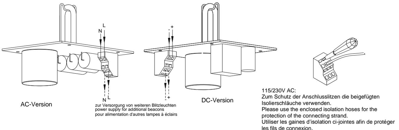
Nach Anschluss der Betriebsspannung, Aufsetzen und Befestigung des Gehäuses ist die Blitzleuchte einsatzbereit.
