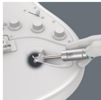
Mit dem im Set enthaltenen Inputjacker kann die Ausgangsbuchse bei Ein- und Ausbau sicher positioniert werden. Die außenliegende Sechskantmutter wird mithilfe der Zyklop Nuss gelöst bzw. angezogen.
