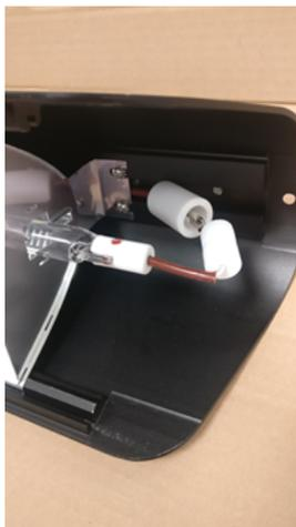
5. Trennen Sie beide Flachsteckverbindungen.
