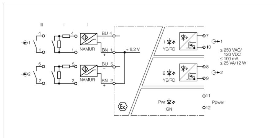
Der 2-kanalige Trennschaltverstärker vom Typ IM1-22EX-MT ist mit eigensicheren Eingangskreisen ausgestattet.
