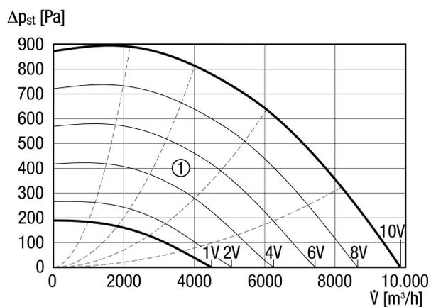
① Hilfskennlinien zu Steuerspannung 1 - 10 V
