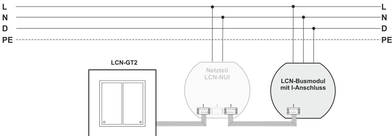
Netzteil LCN-NUI (optional) für Tasten-Hinterleuchtung und Corona®-Lichtkranz
