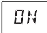
Tasten  $\text{Boost}$  und  $\text{Boost}$  gleichzeitig 3 s lang drücken, um das Programmiermenü zu öffnen.
