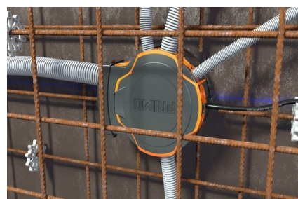
Membraneinführungen mit einem Cuttermesser öffnen. Kabel und (starre) Rohre M9 - M40 einführen. Die Membrantechnik gewährt eine absolut betondichte Einführung.
