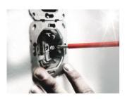
Unerlässlich für den Einsatz bei Reihenklemmen, Sicherungskästen, Schaltern, Relais etc.: Die Profilkombination aus Schlitz und Phillios bzw. VDE-isolierte Schraubendreher mit reduziertem Klingendurchmesser
