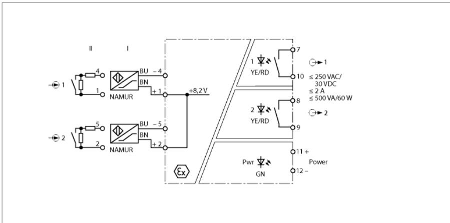
Der zweikanalige Trennschaltverstärker vom Typ IM1-22EX-R/24VDC ist mit eigensicheren Eingangskreisen ausgestattet.
