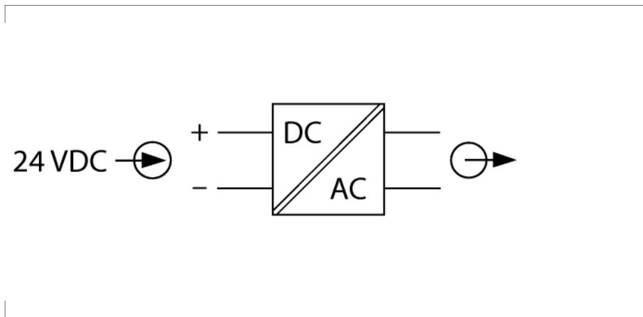
Das Netzteil PSM24-3G dient der Versorgung des excom®-Systems bis zum Vollausbau. Das Netzteil ist in Modulbauform ausgeführt und kann in Zone 2 eingesetzt werden.
