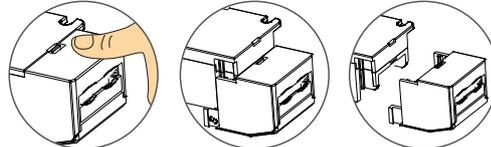
Ziehen Sie die Kappe links und rechts herunter um diese zu entfernen.
