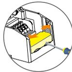
Drücken Sie die Seiten nach außen und entfernen Sie die Zugentlastung indem Sie diese mit einem Werkzeug aufhebeln.
