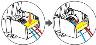
Drücken Sie Zugentlastung herunter um die Kabel zu befestigen
