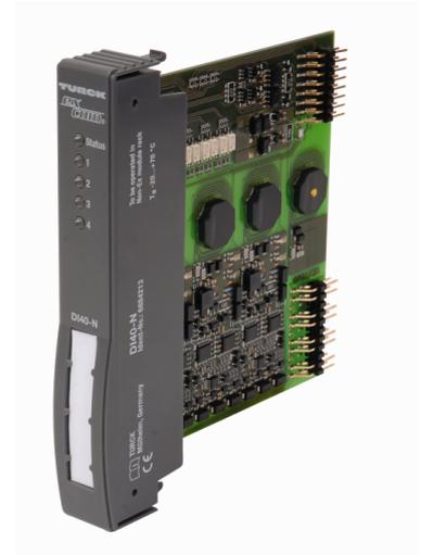
Das Eingangsmodul DI40-N dient zum Anschluss von Sensoren nach NAMUR (DIN EN 60947-5-6), 3-Draht Sensoren (NPN, PNP) oder mechanischen Kontakten.
