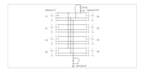
Der sechskanalige Verteilerbaustein vom Typ JBBS-48-E613/3G ist für den PROFIBUS-PA ausgelegt.
