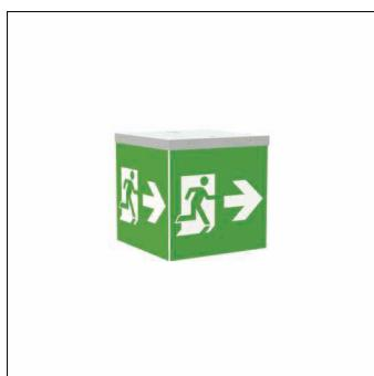
Panik Sign, Rettungszeichenleuchte, aus PC, primäre lichttechn. Abdeckung: Infopanel, Montageart: Anbau, LED, Lichtfarbe: 860, Farbtemperatur: 6000K, Netzanschluss: 230V, AC/DC, 0/50Hz, Bemessungsleistung: 1W, Gehäuse, aus Kunststoff, weiß, Länge: 254mm, Breite: 254mm, Höhe: 250mm, Klemmbereich: 10..15mm, konventionelle Zentralbatterie, Schutzart (gesamt): IP42, Schutzklasse (gesamt): SK II (Schutzwandisoliert), zul. Betriebsumgebungstemperatur: 0..+45°C, Verpackungseinheit: 1 Stück
