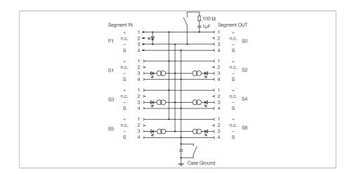
Der sechskanalige Ex-Verteilerbaustein vom Typ JBBS-48SC-E613/EX ist für den PROFI-BUS-PA ausgelegt.
