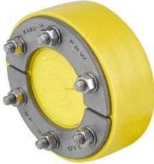
Kabu-IN ist eine Pressringdichtung aus einem weichen Duroplast-Elastomer (PUR) in gelb, in NW 110 zusätzlich mit einem Vollgummikern (EPDM) und Pressflanschen aus Edelstahl.
