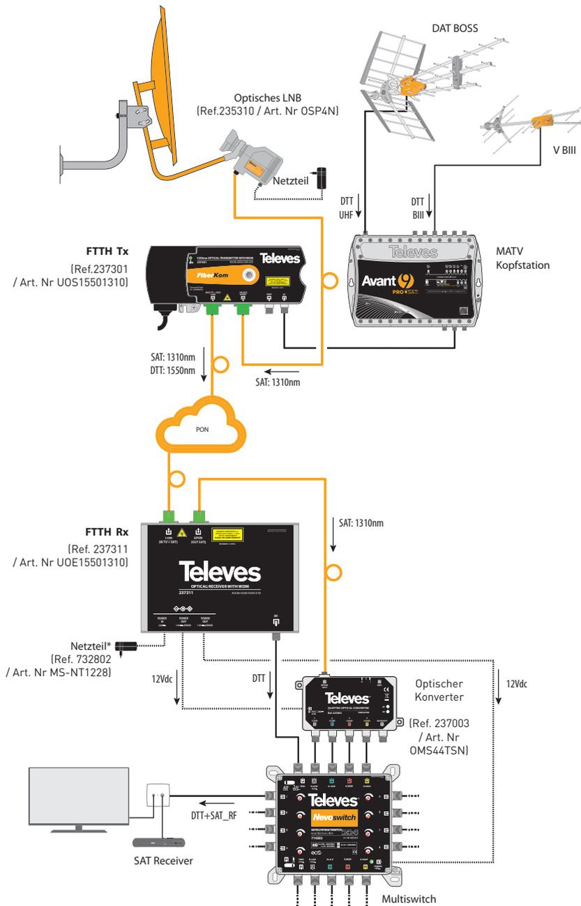
Im FTTH Sender Tx (Ref. 237301 / Art. Nr UOS15501310) werden ein 1310nm Signal eines optischen LNB mit einem 1550nm modulierten DVB-T/T2-Signal gemultiplexed. Beide Signale werden an den FTTH Empfänger Rx (Ref. 237311 / Art. Nr UOE15501310) geschickt. Dieser wandelt das 1550nm Signal in sein DVB-T/T2 HF Signal und verteilt das 1310nm SAT-Signal an einen optischen Konverter (Ref. 237003 / Art. Nr OMS44TSN) zum Umwandlung in ein HF-Signal.
