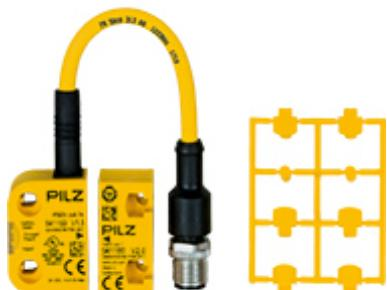
RFID Sicherheitsschalter 2 sichere HL-Ausgänge, 8-pol. M12 Stiftstecker, eine Betätigungsrichtung, Unterstützung für SDD, IP67, Schaltabstand 11 mm, Sao = 8 mm, Sar = 20 mm, reihenschaltbar, VP = 1 Stück codierter Schalter mit Betätigter.
