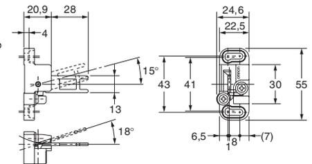
**Bei eingeführtem Betätiger (Verhältnis von Einführungsradius und Einführungsöffnung)**
