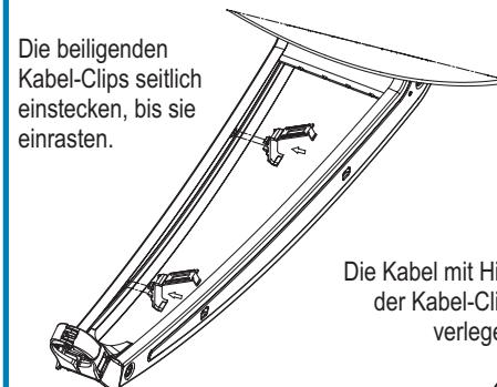
Die Kabel mit Hilfe der Kabel-Clips verlegen.
