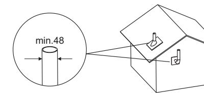
Das Rückenteil gemäß Abbildung am Mast befestigen und die Flügelmuttern leicht anziehen. Die Antenne kann nun ausgerichtet werden.
