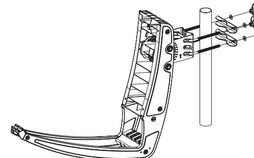
Den LNB gemäß Abbildung montieren. Das Kabel ggf. durch die Gummitülle ziehen und dann F-Stecker, G ummitüllte und Kabel befestigen.
