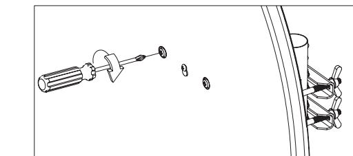
Die vier Reflektor-Befestigungsschrauben mit einem maximalen Drehmoment von 10 Nm anziehen.
