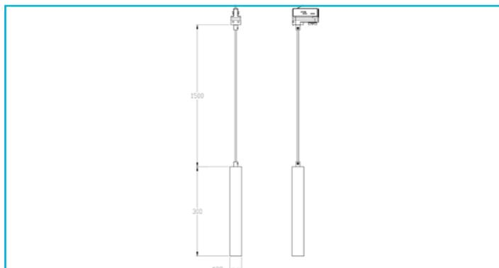
Für das Stromschienensystem gibt es passende Pendelleuchten der SLIM - Serie. Der Leuchtenkorpus aus Aluminium Druckguss ist dabei immer gleich groß [300 x 39mm]. Die Pendelleuchten für die Stromschienen ermöglichen eine Abhängung von maximal 180 cm.
