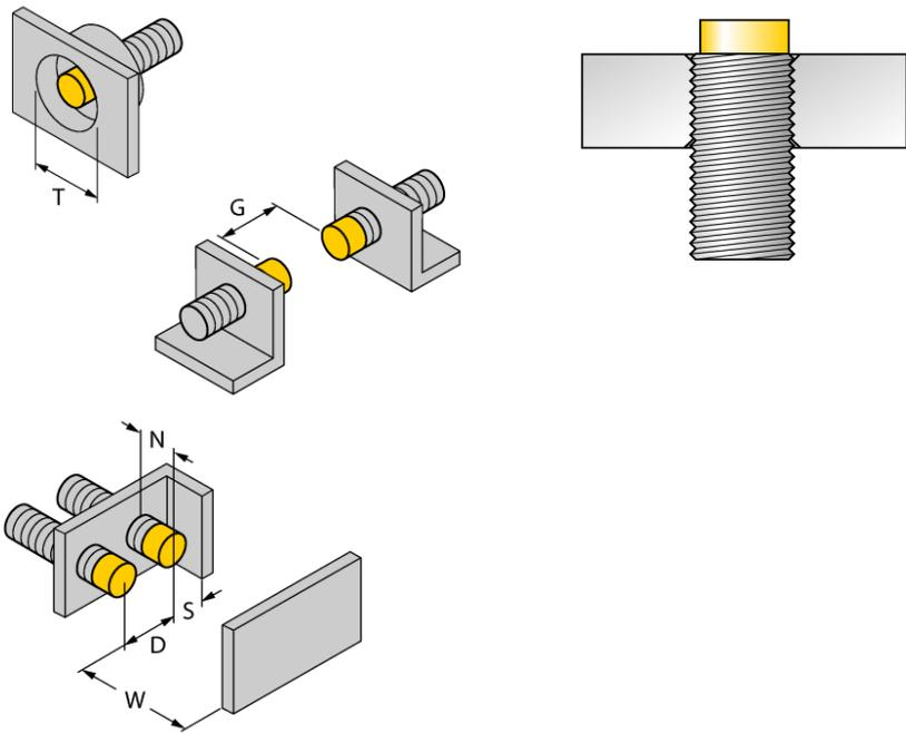
Bei allen nichtbündigen uprox<sup>®</sup>+ Gewinderohrschaltern ist ein Einbau bis zur Rohrkante erlaubt. Ein sicherer Betrieb ist hierbei mit einer maximalen Reduzierung des Schaltabstandes von 20% gewährleistet.
