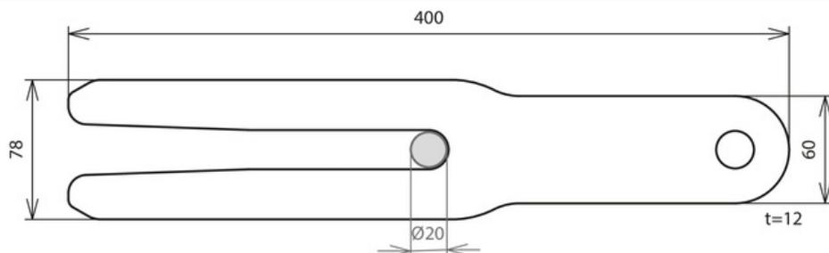
Die Haltegabel dient in Kombination mit einem Auflager zum sicheren Absetzen der Erder über dem Bohrloch.
