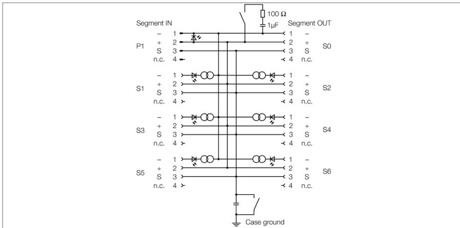
Der sechskanalige Verteilerbaustein vom Typ JBBS-49SC-M613/3G ist für den FOUNDATION™ fieldbus ausgelegt.
