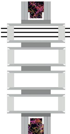
**14.** Gruppen von Boxen in leichten Trennwänden müssen oberhalb und unterhalb durch einen Riegel umfasst werden.
