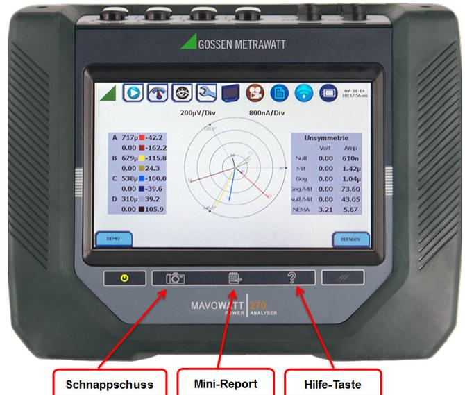
Netzstöranalysatoren der MAVOWATT 2XX-Serie verfügen standardmäßig über drei Bedientasten, die unterhalb des LC-Displays angeordnet sind. Mit Hilfe dieser Bedientasten werden Snapshots erstellt, Protokolle geöffnet und die zu jeder Ansicht verfügbaren Hilfetexte abgerufen.
