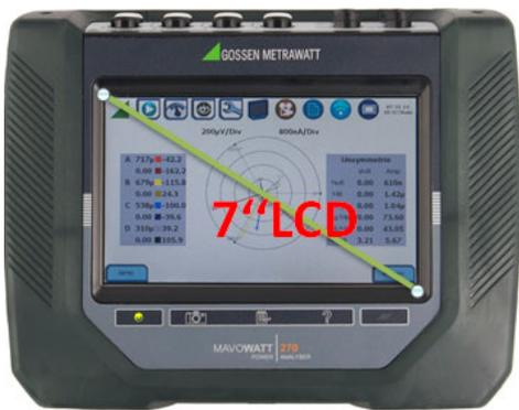
Die Analysatoren verfügen standardmäßig über ein 7" (18 cm)-Farbdisplay mit Touchscreen-Technologie und LED-Hintergrundbeleuchtung. Über diese Anwenderschnittstelle werden alle Gerätefunktionen eingestellt, Echtzeit-Messungen vorgenommen, Daten ausgewertet und Protokolle erstellt.
