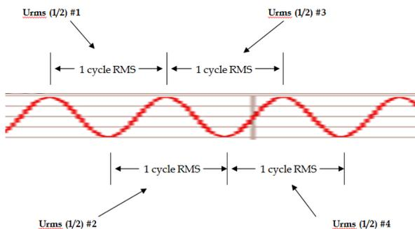
Der Umfang der im Auslösefall zu speichernden Daten wird im Gerätespeicher festgelegt (Parameter "RMS-Werte (Perioden)" / "Kurvenform-Erfassung"). Die Geräte verarbeiten strombezogene RMS-Ereignisse auf die gleiche Weise wie spannungsbezogene. Weitere Informationen hierzu sind der mitgelieferten Bedienungsanleitung zu entnehmen.
